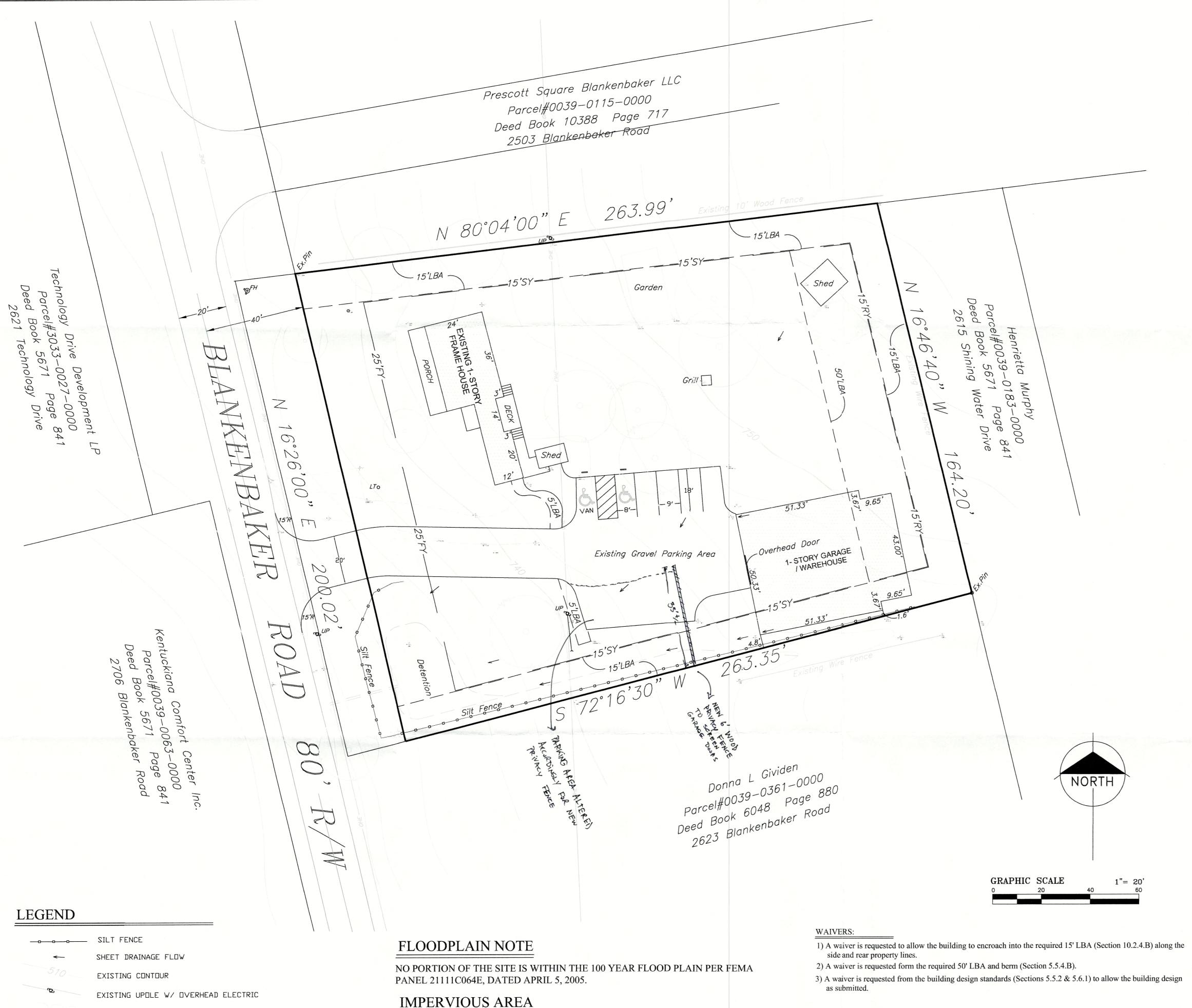
EXISTING IMPERVIOUS- 7,468SF NEW IMPERVIOUS- 3,294SF TOTAL - 10,762F
